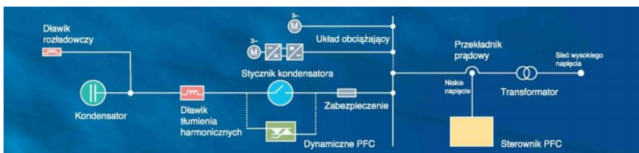
Rys. 1. Schemat poglądowy kompensacji sieci nn
